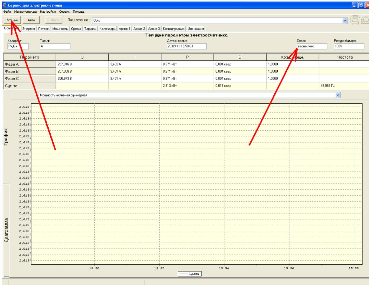
*После проведенных действий счетчик не будет изменять сезон, т.к. установленные старые даты никогда не наступят. Проводить указанные действия со счетчиками можно по оптопорту либо через внешние интерфейсы.*
